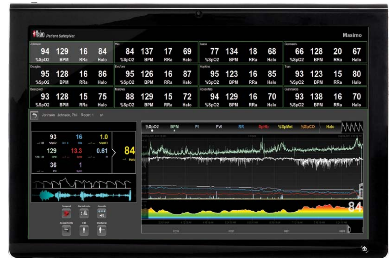
在本例中, Halo Index 指示患者状态恶化, 同时显示参数趋势及其对于 Halo Index 的作用*。Patient Safety 可以显示实际参数值 (上) 或颜色编码的报警状态 (下)。
